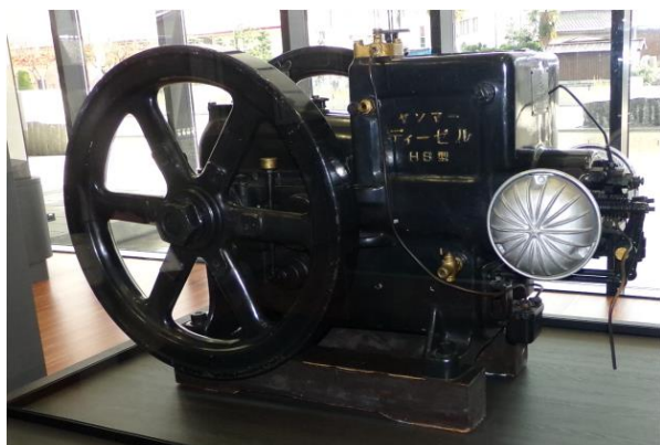
左：機械遺産（ヤンマー小形横形水冷ディーゼルエンジンHB形） 右：永源寺ダム（複合ダム：図左ロックフィル、右コンクリート）
